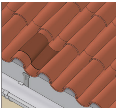
Reparação de telhas partidas/fissuradas.
