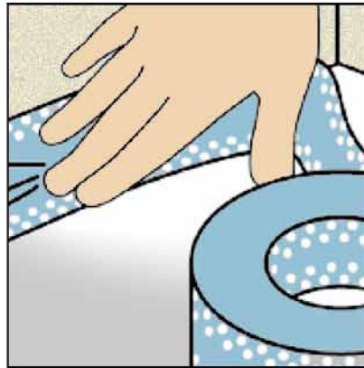
2. Colocar Banda de estanqueidad autoadhesiva en las esquinas y sobre las juntas
