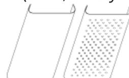
Lâmina nervurada (OABN) e grelha de iluminação (OABG) com 84 mm
